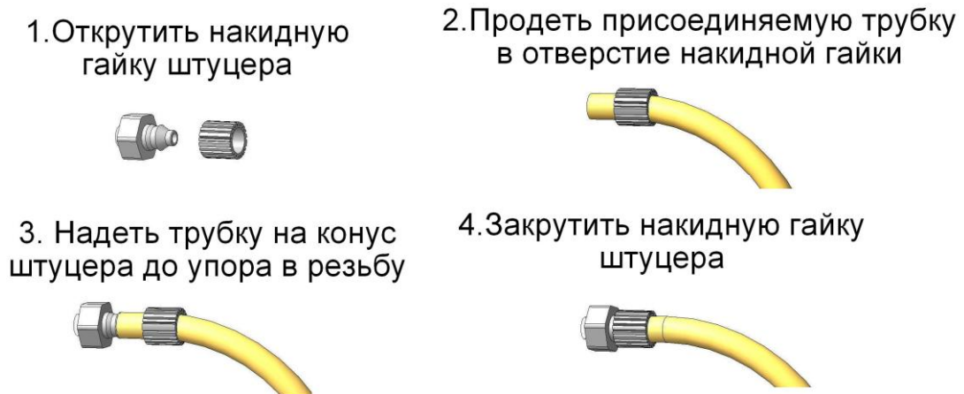
Рисунок 2.2 – Последовательность соединения трубки со штуцером
